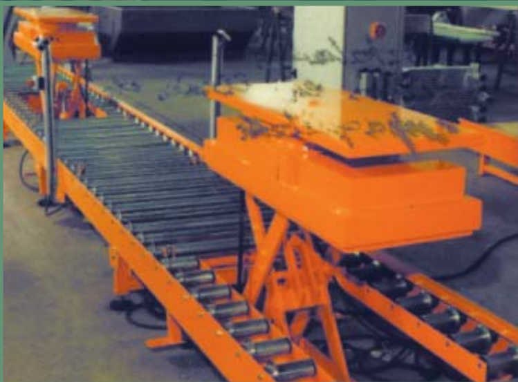
Instalación de rodillos motorizados con plataformas de elevación.
